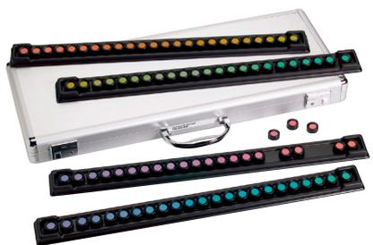
操作儀器的操作員與視覺評估問題的技術解決方案同樣重要。SpectraLight QC 的用戶可編程功能允許供應商根據品牌所有者對於光源、照度水平和其他參數創建自定義配置文件，確保操作者使用每個程序核準的燈和準確的設置。該系統還可以將這些信息生成報告與客戶共享，以確定任何不一致的內容。還可以創建個人操作員資料文件，從而在這些文件中記錄他們的 Farnsworth-Munsell 100 色相測試得分。據專家估計，多達 2% 的女性和 7% 的男性有色覺缺陷。在過去，品牌所有者可能每年需要派出一個操作員兩次，到世界各地「校準」其整個供應鏈的視覺評估工具。利用 SpectraLight QC，可通過 PC 共享客戶對儀器設置的偏好和對操作者視力的要求信息，以提高精確度和符合性。
