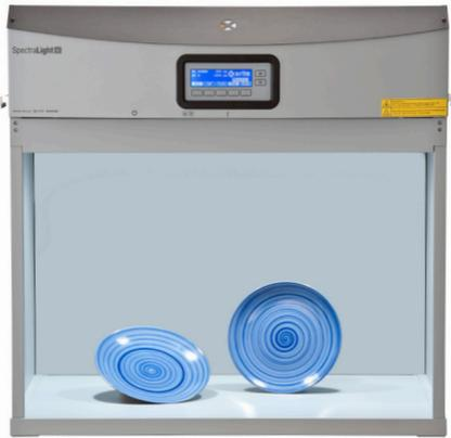
SpectraLight QC 所採用的照明技術優於市場上的任何光源箱。由於本儀器具有的光源數量較多 — 包括日光、白熾光「A」、水平日光、三種熒光（CWF、U30、U35、TL83 和 TL84 之間的任何組合）和 UVa，數量超過任何其他產品，因而可以應用於任何規格。集成光傳感器提供熒光燈照度的實時數字輸出，並可以通過操作員設置以滿足行業標準，如 ASTM 和 AATCC。儀器的閉環熒光燈控制使得操作員可以從一個光源移動到下一個光源，而無需等待需要的預熱時間。相同的傳感器和電子產品，確保實時控制所有的熒光燈，保持燈泡整個使用期間的精確照度。SpectraLight QC 還提供出廠校準的紫外線，使用戶能夠根據樣品需求（基於應用）調整紫外線量。
